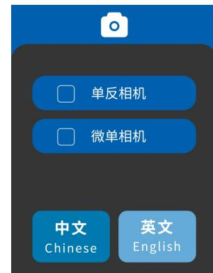
进入 [ 拍拍宝 ] 页面，首先选择安装的相机类型，选择单反相机或微单相机；数码相机是否可以休眠、LCD屏是否关闭，单反相机与微单相机在拍摄逻辑上是不同的。选择后，智能摄影盒会用对应的拍摄指令来满足数码相机不同设置时的状态。如果没按照上述要求使用智能摄影盒，数码相机的拍摄可能出现紊乱，拍摄行动可能失败。
