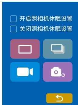
选项【开启照相机休眠】，指数码相机设置了可以休眠。当拍摄结束达到一定时间，数码相机的节电功能会让数码相机进入休眠状态。
