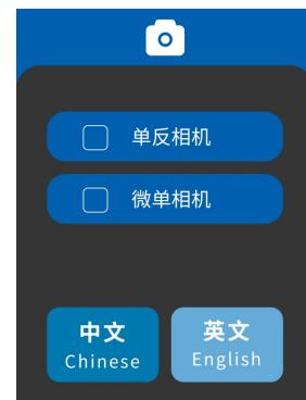
进入 [拍拍宝] 页面，首先选择安装的相机类型，选择单反相机或微单相机；数码相机是否可以休眠、LCD屏是否关闭，单反相机与微单相机在拍摄逻辑上是不同的。选择后，智能摄影盒会用对应的拍摄指令来满足数码相机不同设置时的状态。如果没有按照上述要求使用智能摄影盒，数码相机的拍摄可能出现紊乱，拍摄行动可能失败。
