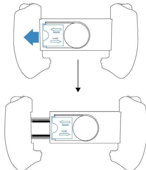
如右图所示为手柄拉开的状态，注意在拉开到宽度比夹持平板电脑小 5-10mm 位置，锁紧背面的卡扣。
