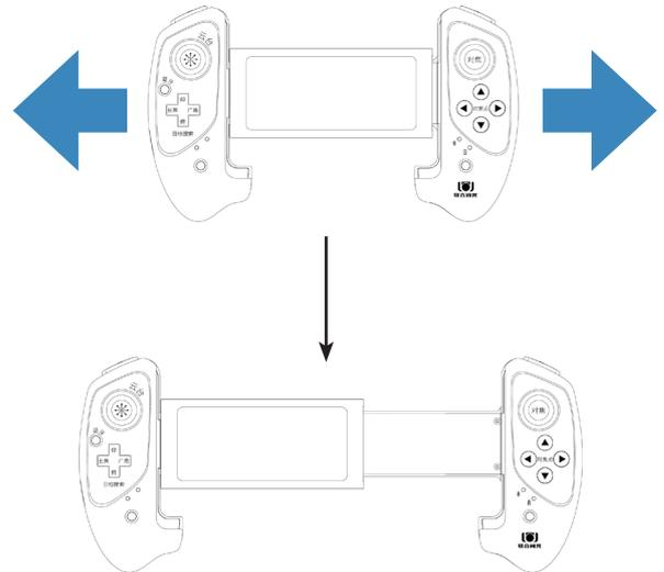
**b** 如图所示，左右拉开支架，从上往下装入平板电脑，平板电脑装到底部后松开，手柄会自动夹紧平板电脑。
