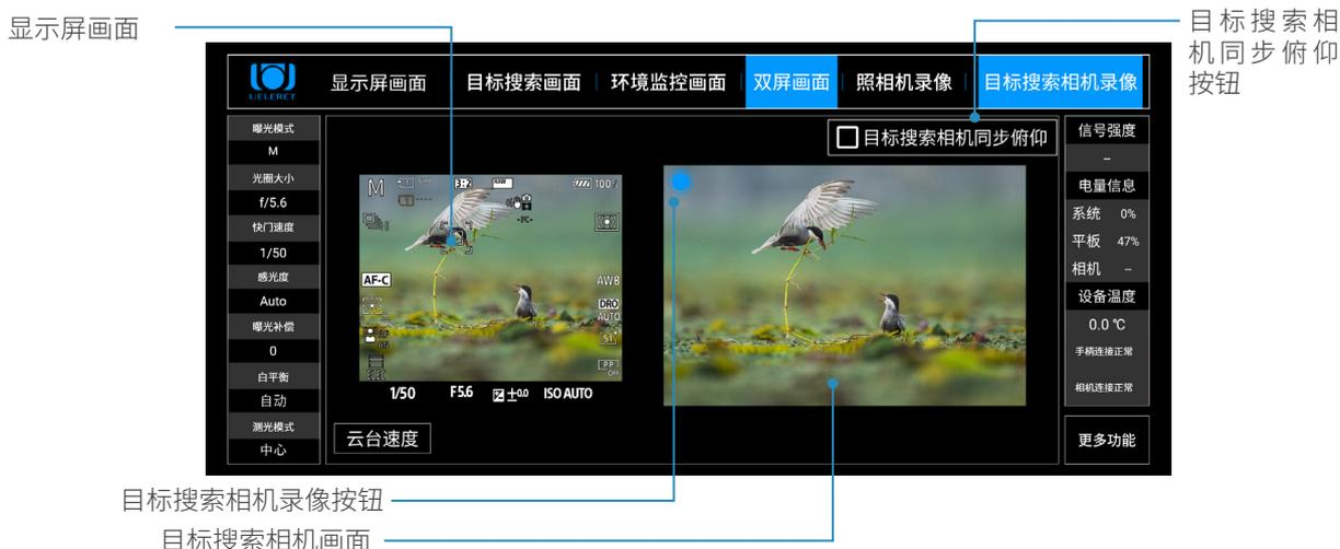
该界面，左边是照相机显示屏画面，右边是目标搜索相机拍摄的画面，此时可以通过手柄遥控执行照相机拍摄静止影像，也可以通过平板电脑执行目标搜索相机录像功能，或者两者同时进行。点击同步俯仰，目标搜索相机画面将随显示屏画面的俯仰同步俯仰，详情见 P25 页。
