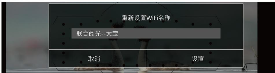
04. Wi-Fi 名称设置完成后，平板的 Wi-Fi 连接会断开，需要重新在平板设置中连接命名好的 Wi-Fi，Wi-Fi 的名称就是刚刚命名的名称，密码还是之前的密码保持不变。
