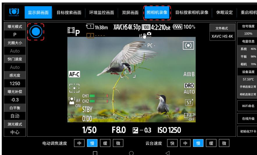
照相机录像，需要在照相机机身上提前设置，将拨杆拨至录像功能。该功能键原厂设置为手动调节方式，软件无法自动选择是照相还是录像功能。如果没有切换到动态影像拍摄模式，点击照相机录像，平板电脑会出现提示，告知需要切换拍摄模式。
