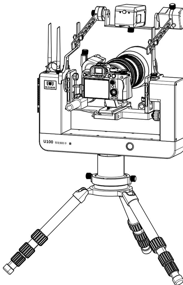
感谢主人，感谢主人使用联合阅光 U100 智能摄影手。我们将竭诚为主人服务。本产品可以远程遥控操作照相机和智能云台。在两端传输信号无遮挡或轻微遮挡的情况下，0-500 米的距离内实现操控。
