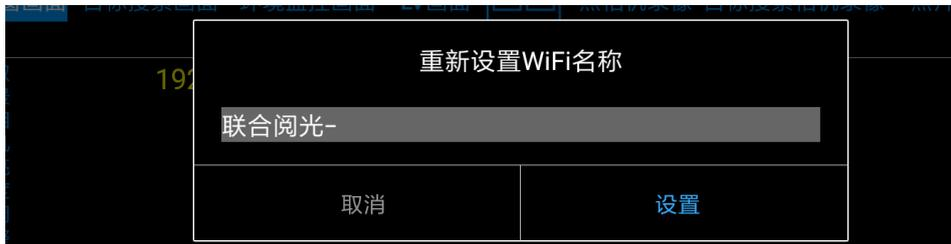
03. 编辑框中会默认显示“联合阅光-”字头，“联合阅光-”四个字是无法删除的，用户可以在后面添加自己想设置的名称，比如“联合阅光-大宝”（最多六个汉字），编辑完成后，按设置按钮，即可完成设置。
