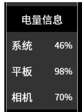
平板电脑电量在 20% 以下时，会自动进入节电模式，图像解码能力会严重下降。此时屏幕会产生花屏和延时现象，请及时充电。
