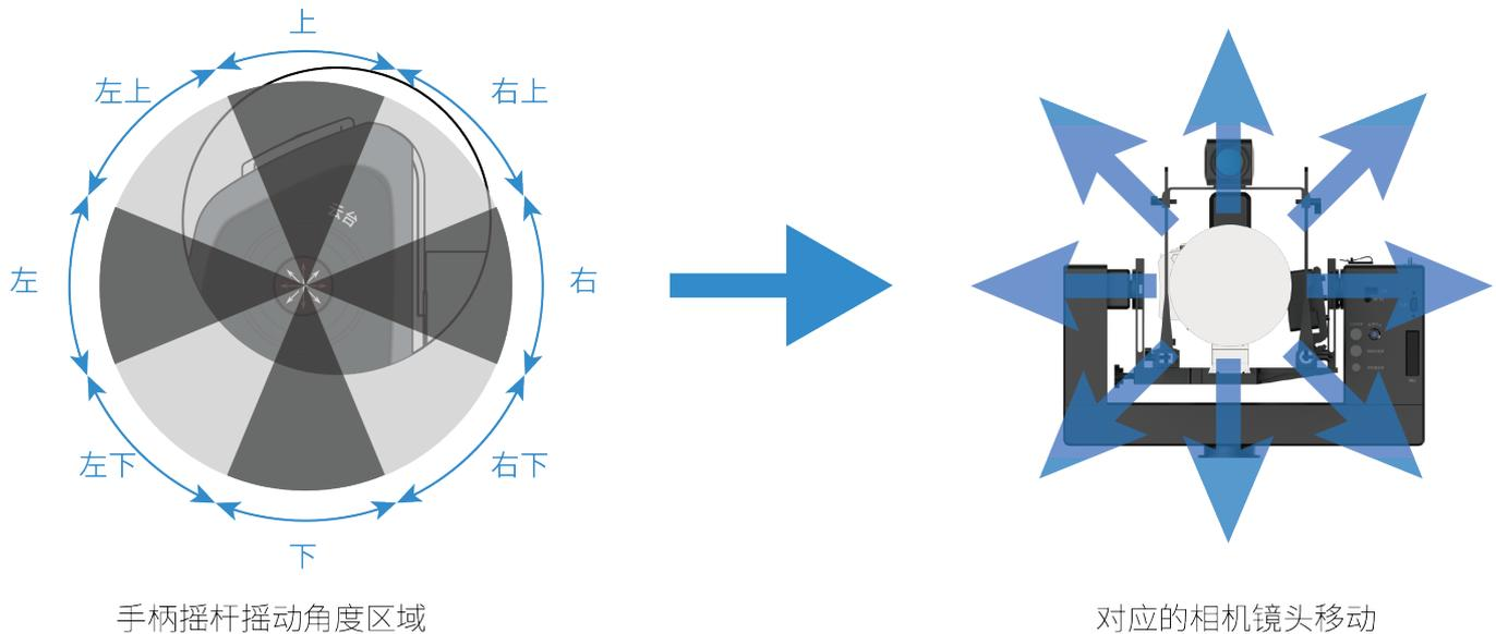
2. 同时检查平板电脑的画面（画面应该切换到显示屏画面或者目标搜索相机画面）是否相应的在同步转动，当云台的水平旋转和俯仰调节到达最左 / 右端，最上 / 下端，平板界面底部会有“左 / 右 / 上 / 下已限位”的提示。
