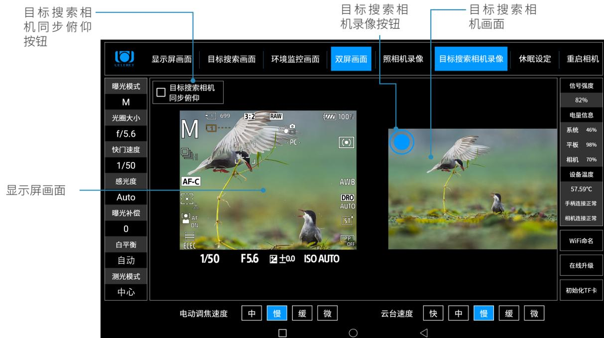
该界面，左边是照相机显示屏画面，右边是目标搜索相机拍摄的画面，此时可以通过手柄遥控执行照相机拍摄静止影像，也可以通过平板电脑执行目标搜索相机录像功能，或者两者同时进行。点击同步俯仰，目标搜索相机画面将随显示屏画面的俯仰同步俯仰，详情见 P25 页。
