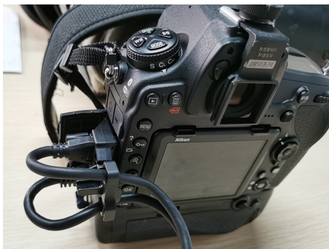
图示： D850 相机安装数据线保护夹
